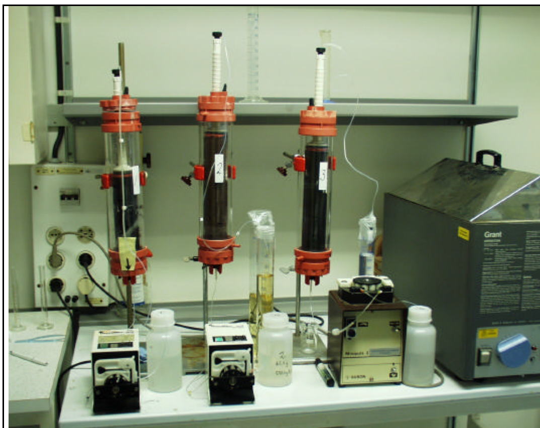
Figur 1. Kolonnförsök för bentonitsand, resolsand och bottenaska
