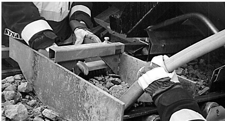
Figur 3.4 Provtagning av tegel från produkttransportör
