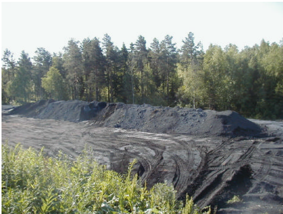
Figur 6-11 Torkning av deponiaska
